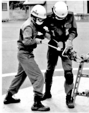
手動式油圧コンビツール：障害物等の切断・拡張・潰し作業に活用
