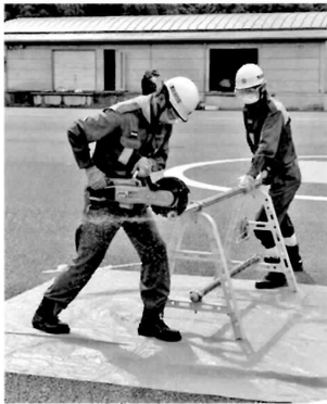
エンジンカッター：木材・金属・コンクリート等の切断作業に活用
