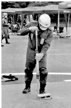
ストライカー：コンクリート・レンガ・板金属を打ち砕く作業の他、車のこじ開け等救助・破壊作業に活用
